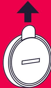
Verwijder het plastic lipje om de Smart Button in de koppelingsmodus te zetten. De LED aan de voorkant begint één keer per seconde te knipperen.\*
