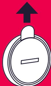
Retirez la languette en plastique pour mettre le Smart button en mode appairage. Le voyant à l'avant commencera à clignoter une fois par seconde.\*
